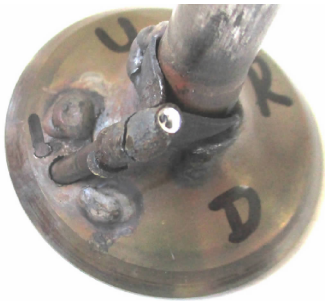
图 7 排气门上的定位标记 Fig. 7 Positioning marks on exhaust valves
